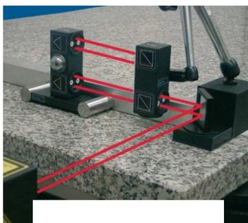
**平面度测量组件，用于平面度测量，可达15 x 15 m。**
