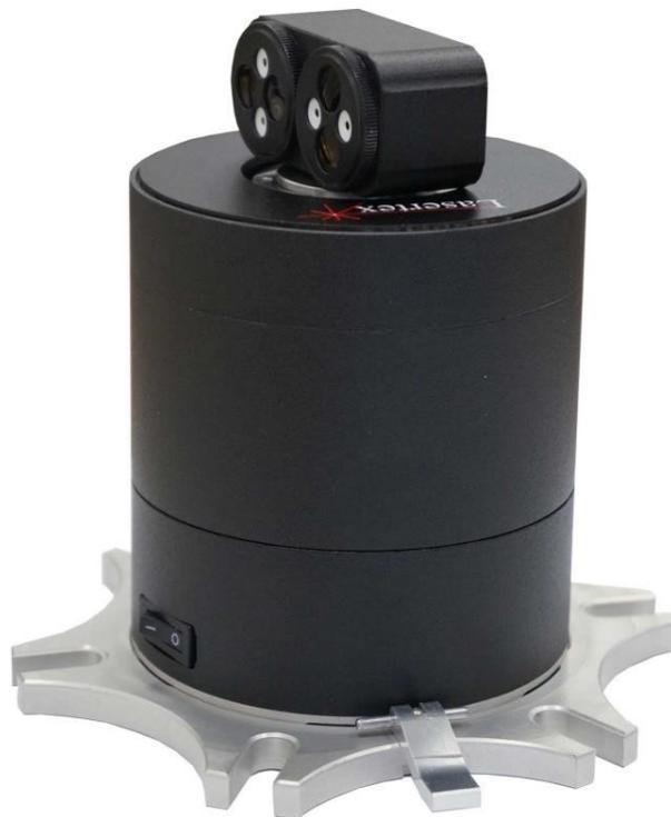
特殊设计的无线回转轴校准组件，实现单一转轴精确角度位置测量。通过自身硬件的测量结果与机床控制器的显示数据进行对比来完成设置准备。用于测量高精度机床的精确角度定位精度和旋转间隙，回转轴校准组件为高精度旋转机床的测量与校准提供了新的解决方案。回转轴校准组件是 HPI-3D 激光干涉仪测量系统的升级组件，整套系统可以为旋转轴角度位移测量和校准提供最高的精度等级，精确旋转角位移的测量功能集成在 HPI-3D 测量软件中，用户无需另外学习使用其他的测量软件。回转轴校准组件拥有独立的夹具配件，提供灵活的安装固定方式，仅需几分钟就可以快速完成对光设置，内置锂电池，续航时间可达 30 小时连续操作。为机床设备的精确测量校准提供有力保障。
