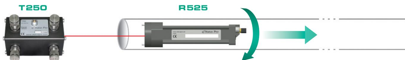
Das Ergebnis ist eine lineare Messung der Bohrungsmittelpunkte mit Abweichungen in X (Seite) und Y (Höhe).
