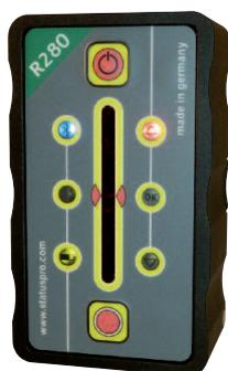
Der R280 misst die Position des rotierenden Laserstrahls wie eine Messuhr den Abstand von dem Werkstück zur Referenz. Der Laserstrahl bildet eine ganze Referenzebene und nicht nur eine Linie wie ein Draht. Der R280 hat eine Reichweite von bis zu 80 Metern, eingebautes Bluetooth und einen wechselbaren Li-Ion Akku für 8 Stunden Messzeit.
