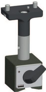
Der schaltbare Magnethalter wird eingesetzt, um den R280 auf einer Messfläche zu befestigen. Der R280 ist in seiner Sensorachse auf diesem Adapter frei drehbar ohne eine Arretierung lösen oder fixieren zu müssen. Durch die Konstruktion ist der Adapter während der Drehung in seiner Achse höhenstabil.
