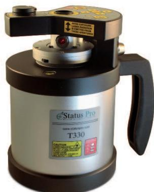
Der selbstnivellierende Rotationslaser T330 liefert in dem Vermessungssystem die Laserquelle, ein Laserempfänger misst die Strahlenposition. Selbstnivellierung, Detektorintelligenz und besonders einfache Bedienbarkeit sind die Merkmale, welche die Ebenheits- und Geradheitsmessungen mit dem Rotationslaser besonders präzise und zuverlässig machen. Selbst komplexe Geometriemessungen sind einfach und schnell beherrschbar.
