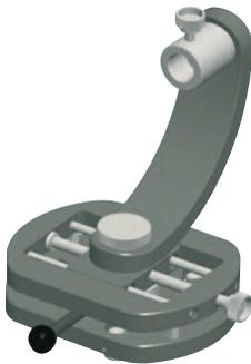
Mit Hilfe des Dreh- und Schwenkadapters kann der Laser T330 in seiner Lage verändert werden. Dies ermöglicht eine horizontale, vertikale oder auch freie Ausrichtung der Laserebene und des Laserstrahls im Raum. Neben der Schwenkmöglichkeit kann der Laser auch exakt parallel verschoben werden, was bei der Einrichtung des Lasers auf eine Referenzlinie sehr hilfreich ist.
