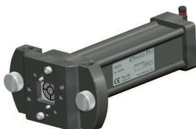
Der R525 ist ein sehr robuster und präziser 2D Laser-Positionsdetektor, der für die Vermessung der Geradheit von Linearführungen an Werkzeugmaschinen entwickelt wurde. Die Verbindung zur Auswerteeinheit findet über Bluetooth statt. Kombiniert mit der Software ProLine und einem Bluetooth Distanzmessgerät können X,Y und Z zeitgleich gemessen und dokumentiert werden. Mit dem T330 als Laserquelle ist die Referenz auch selbstnivellierend.
