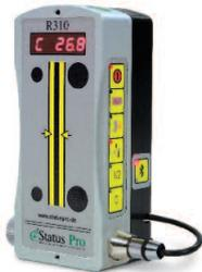
Der R310 misst die Position des rotierenden Laserstrahls wie eine Messuhr den Abstand von dem Werkstück zur Referenz. Der Strahl bildet eine ganze Referenzebene und nicht nur eine Linie wie ein Draht. Der R310 hat eine Reichweite von bis zu 80 Metern, ein Display und eine Tastatur zur vollständigen Steuerung auch ohne Software. Zur Softwareanbindung optional mit Bluetooth zu erhalten.
