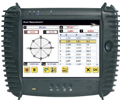
Robuster Touchscreen PC mit Magnesiumgehäuse und Gummiprotektoren. Der PC ist für den Baustelleneinsatz geeignet. Interne Datenanbindung zur Status Pro Sensorik über USB und Bluetooth.
