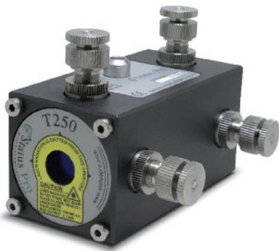
Der T250 Laser ist eine hochentwickelte Laserquelle die bei beengten Platzverhältnissen zur Anwendung kommt. Dieser Laser zeichnet sich ebenso wie der T330 durch seine hervorragende Strahlqualität aus. Die Laserquelle ist über die 4 Differentialschrauben in der Lage und im Winkel einstellbar. Die Stromversorgung erfolgt über ein Netzteil.
