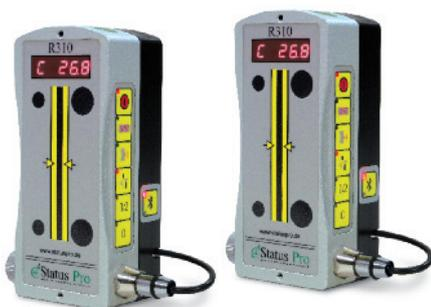
Der R310 misst die Position des rotierenden Laserstrahls wie eine Messuhr den Abstand von dem Werkstück zur Referenz. Der Strahl bildet eine ganze Referenzebene und nicht nur eine Linie wie ein Draht. Der R310 hat eine Reichweite von bis zu 80 Metern, ein Display und eine Tastatur zur vollständigen Steuerung auch ohne Software. Zur Softwareanbindung optional mit Bluetooth zu erhalten.
