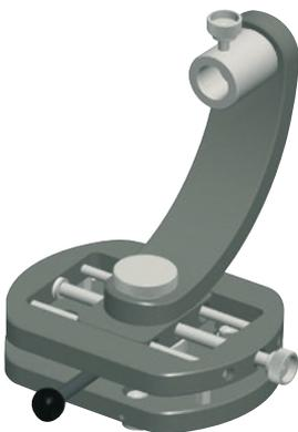
Mit Hilfe des Dreh- und Schwenkadaptors kann der Laser T330 in seiner Lage verändert werden. Dies ermöglicht eine horizontale, vertikale oder auch freie Ausrichtung der Laserebene und des Laserstrahls im Raum. Neben der Schwenkmöglichkeit kann der Laser auch exakt parallel verschoben werden, was bei der Einrichtung des Lasers auf eine Referenzlinie sehr hilfreich ist.
