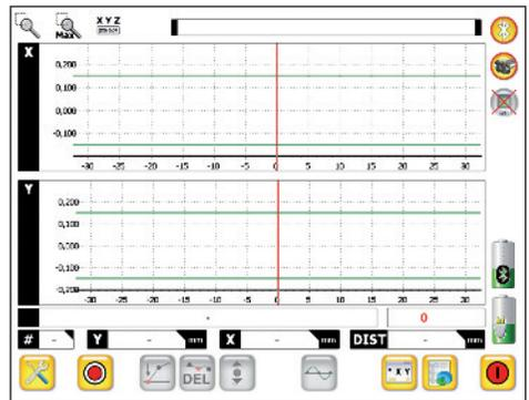
Hier werden die aktuelle Winkellage des Empfängers, die X-Koordinate und die Y-Koordinate angezeigt. Mit Hilfe dieses Monitors können der Laser und der Empfänger in der Bohrung ausgerichtet werden.
