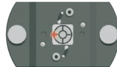
Beide X-Stellschrauben um den gleichen Wert hineinschrauben. Der Laserstrahl wird in der Seite verschoben (seitlicher Versatz).
