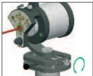
6. Nun ist der Laserstrahl mittels Justierschraube des Lasersenders T310 mittig auszurichten.
