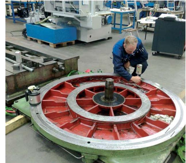
Eine effektive Flanschvermessung ist dank Bluetooth, 80mm Empfänger und Rotationslaser schnell und einfach durchzuführen. Die Ergebnisse können sofort in 3D betrachtet und ausgewertet werden. Ausgleichsebenen, Flansch-Parallelitätsmessung und Datenaustausch sind Grundbestandteile des Systems.
